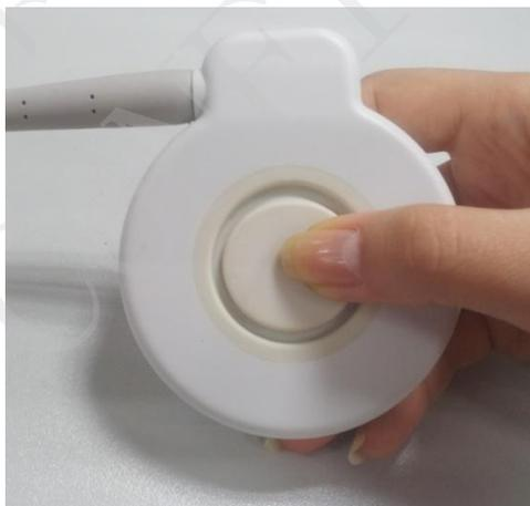
Figure 7-7 Test d'un transducteur TOCO
