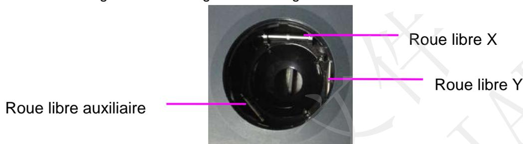
Figure 12--2 Roues libres X, Y et auxiliaire
