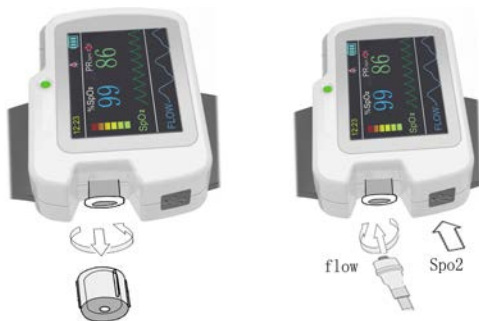
Fig. 4-3-1-1 Branchement de la canule
