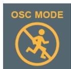
Une icône orange représentant un « coureur » dans un cercle barré indique que le moniteur est réglé pour effectuer des mesures de la pression artérielle en mode OSC oscillométrique (repos). Le patient doit rester immobile.
