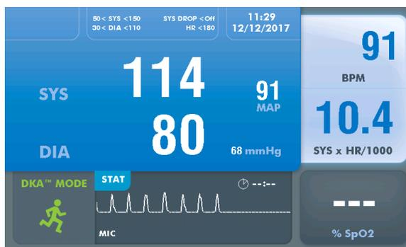
Le réglage par défaut pour le mode STAT est d'effectuer une mesure PA complète, incluant la mesure de la pression systolique et diastolique toutes les 10 secondes à partir de la fin de chaque mesure. Le moniteur peut être réglé de sorte à effectuer des mesures de la pression systolique uniquement, toutes les 2 secondes. Pour ce faire, sélectionnez Menu principal > Configuration des mesures > Touche « Stat Mode ».
