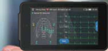
Le moniteur LEPU PCECG-500 permet la collecte, l'analyse, le stockage et la transmission d'informations ECG à 12 dérivations, qui, en combinaison avec l'algorithme de Glasgow, fournissent une analyse complète et immédiate.
